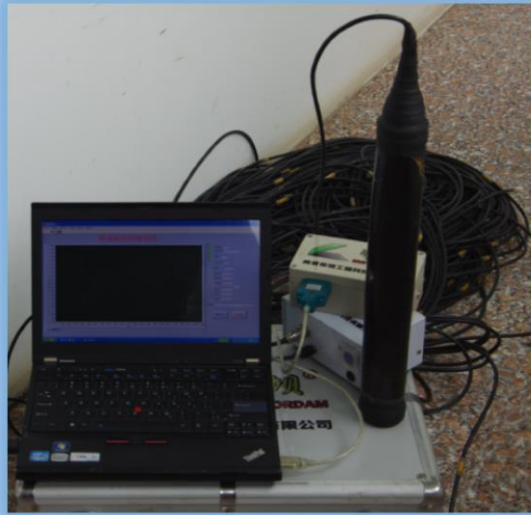
图1 水工渗漏声纳检测系统
